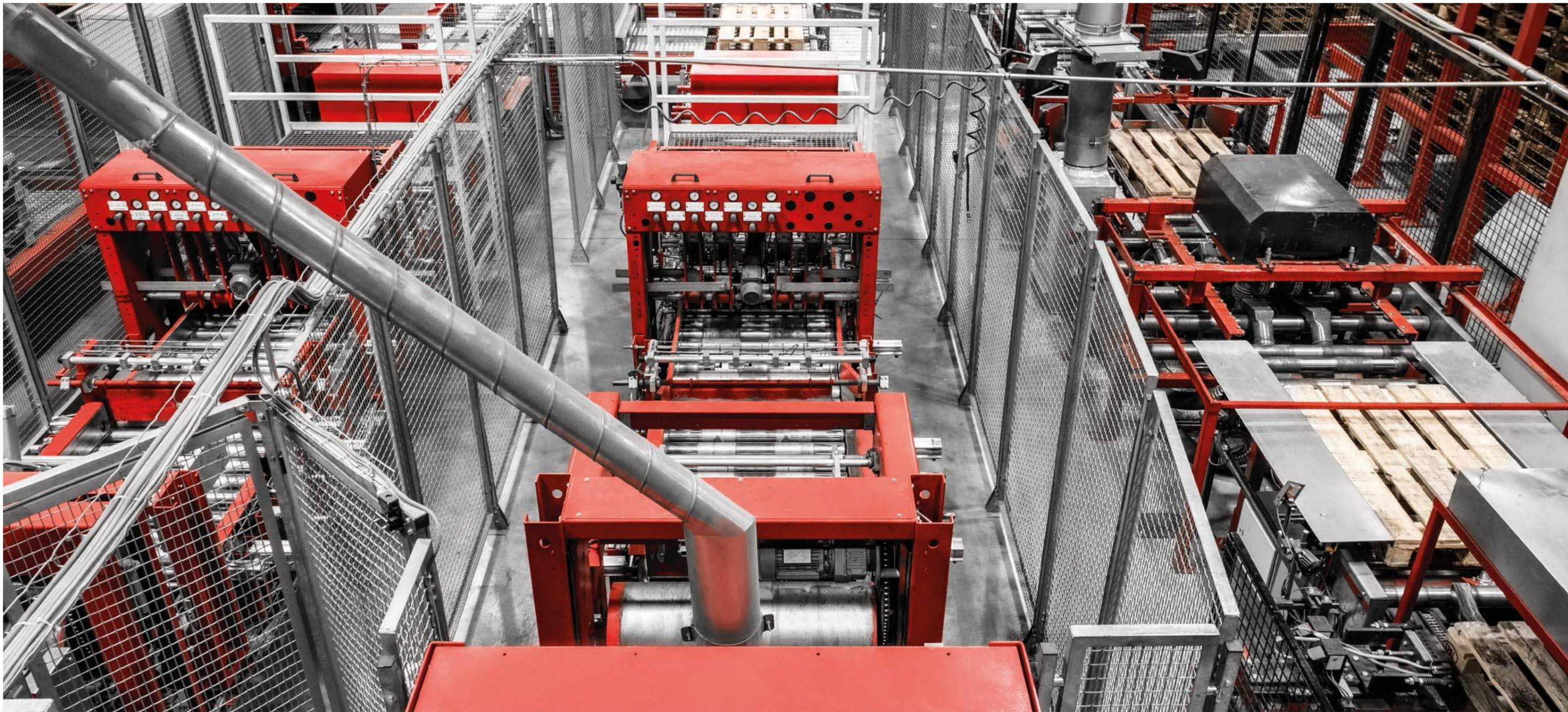
Wir prüfen mit diesem automatischen Prozess EPAL Europaletten mit Hilfe mechanischer Checks und anhand von moderner Laser- und Fotozellen-Technologie auf ihren individuellen Zustand.
