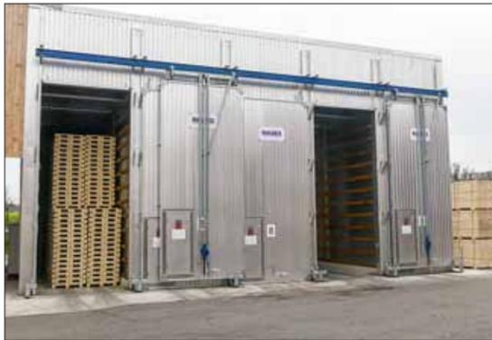
Die fünf neuen Trockenkammern sind eher klein, um die Bestückungs- und Entnahmezeiten zu verkürzen. Sie nehmen Paletten für jeweils eine Lkw-Ladung auf.
