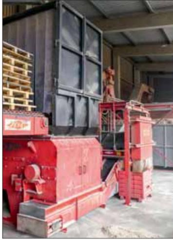
Die Hackschnitzel landen entweder zum Verkauf im Container oder zur eigenen Nutzung im Schubboden (rechts).
